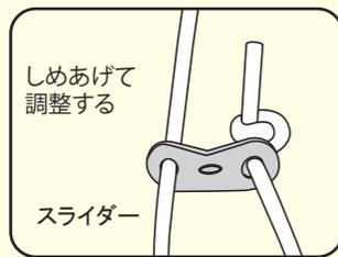
4ヶ所にロープをセットし、テント本体から60cm～1m程離れた位置にペグ打ちして固定します。スライダーをしめあげて、ポールが安定する位置で固定して下さい。
