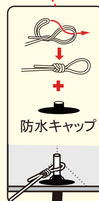
ロープと防水キャップ 取り付け方
