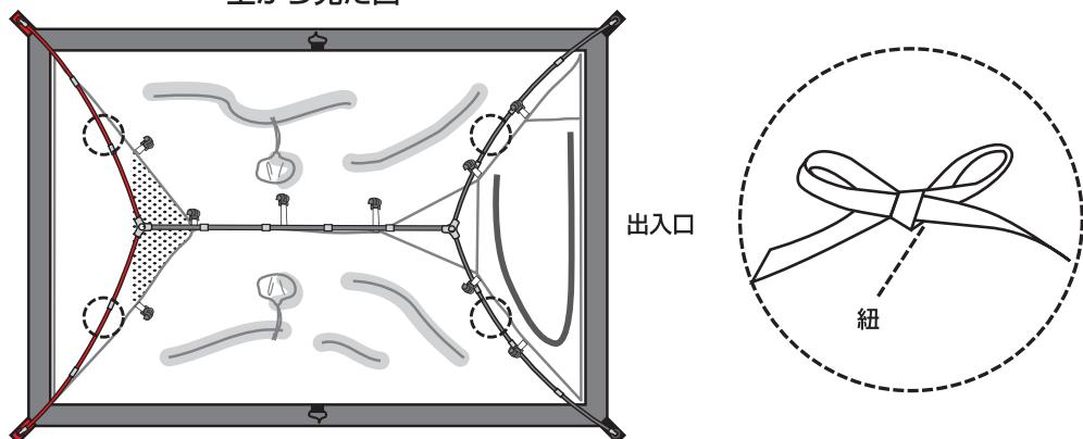
手順7・フライシートとテント本体下図〇の4カ所全てのバックルを接続します。
